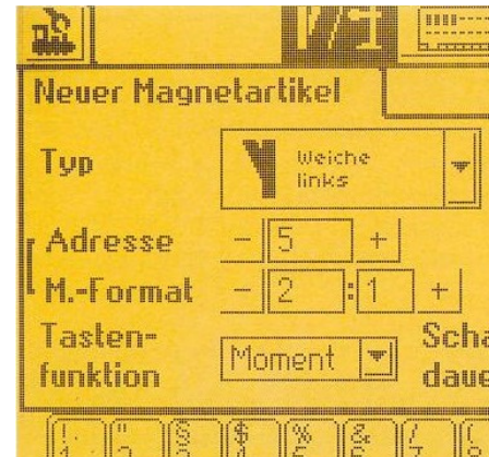
Het adres "5" wordt ingesteld, daaronder verschijnt automatisch het oude adres.
