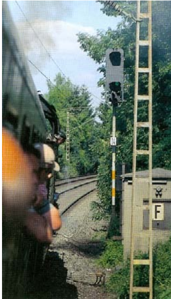
Bloksein 14 toont groen licht. De loc mag weer stomen. Even later staat het volgende bloksein op stoppen omdat er een langzamere trein voor ons rijdt. Het huisje met F bevat een telefoon.
