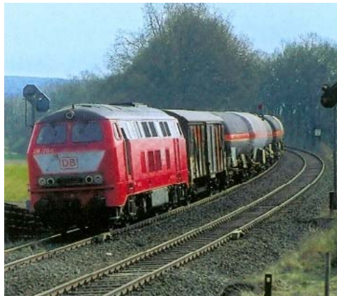
De goederentrein is sein 2 gepasseerd en rijdt nu op het dubbelsporige gedeelte. Sein 1 is hier een uitrijsein.
