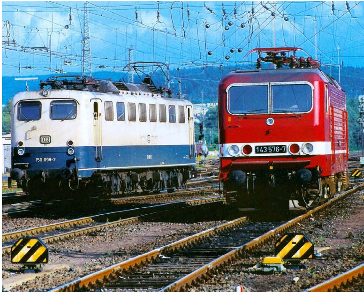
In het station beveiligen sperseinen de loc-wachtsporen. In veel gevallen treft men het dwergsein aan.
