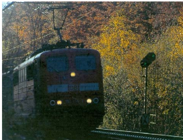
Dit voorsein toont "doorrijden verwachten". Het volgende hoofdsein mag met de maximum toegelaten snelheid worden gepasseerd. Dat geldt echter niet voor het tegemoetkomende verkeer.
