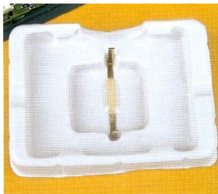
De verpakking doet het: het ingelijmde metaalcontact zorgt ervoor, dat de seinbesturingsmodule automatisch de adresseermodus activeert.
