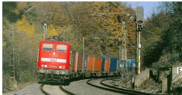
Blokseinen staan op de vrije baan. De elektrische inrichtingen zijn in de schakelkast geplaatst. Een betonnen huisje is hier niet aanwezig; deze worden pas bij de modernere nieuwbouwtrajecten gebruikt.
