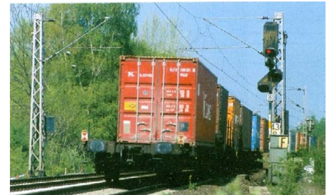
Nadat de loc het bloksein is gepasseere schakelt het onverboddelijk op rood. Het voorsein is gedoofd.
