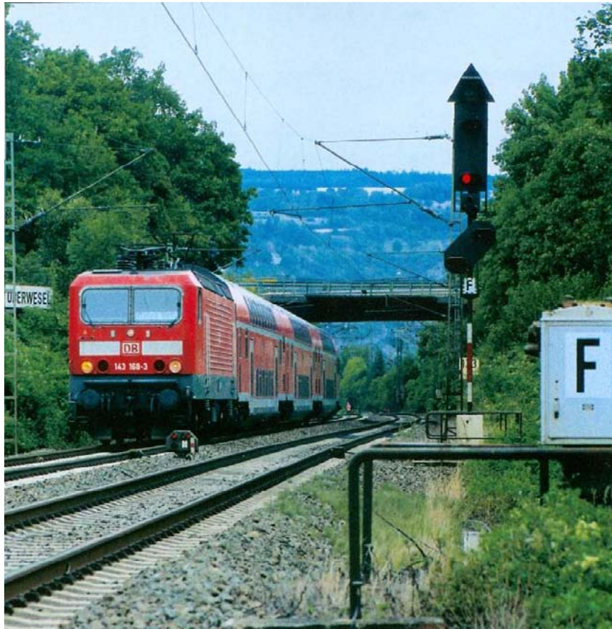
Seincombinatie voor "Linksfahren auf Signal Zs8".
