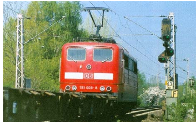
Kort voor de loc het sein bereikte, is het volgende blok vrijgegeven. De 151 kan hierdoor verder rijden zonder remmen.
